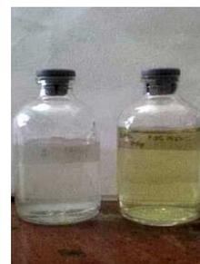
**Gambar 5** Warna larutan kromium sebelum (botol kiri) dan setelah adsorpsi (botol kanan).
