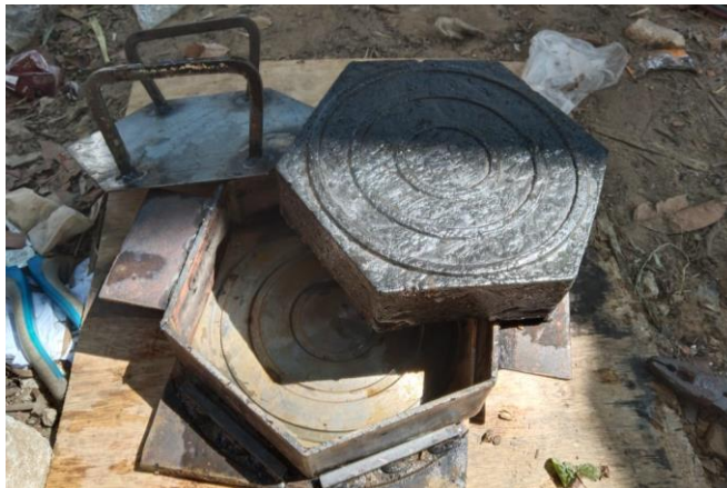
Gambar 4.4 Kondisi Batako Setelah Dikeluarkan dari dalam Cetakan
